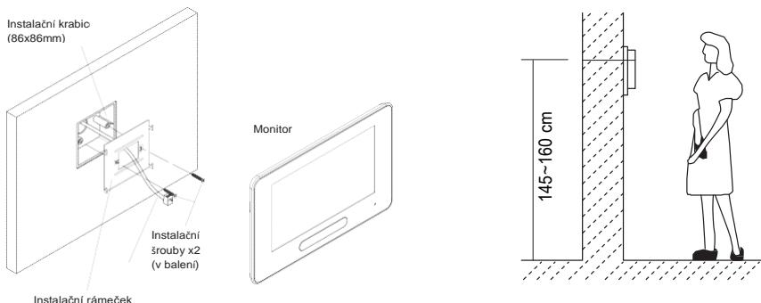
1. Upevněte instalacní rámeček pomocí šroubů do instalacního boxu ve zdi.
