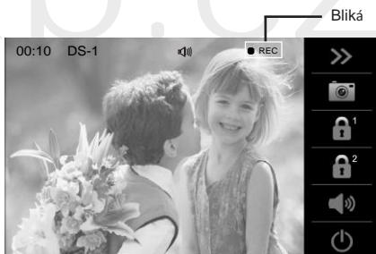
Snímky jsou uloženy primárně ve vnitřní paměti (max. 118 snímků).
